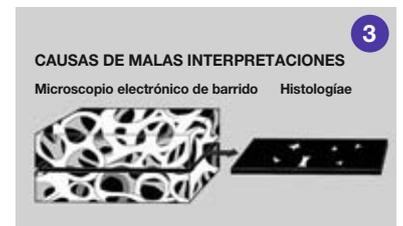
A la izquierda se muestra la estructura tridimensional de la microespuma de poliuretano tal como se apreciaría con un microscopio electrónico de barrido. Después de preparar secciones histológicas, la estructura aparece como un fragmento, a pesar de que no está fragmentada.
